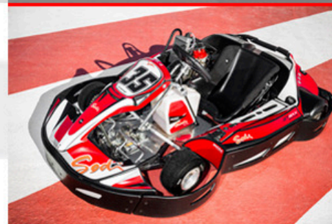
KARTS SODIKART/ROTAX MAX 2T 21 CV. VELOCIDAD MÁXIMA 105 KM/H.
